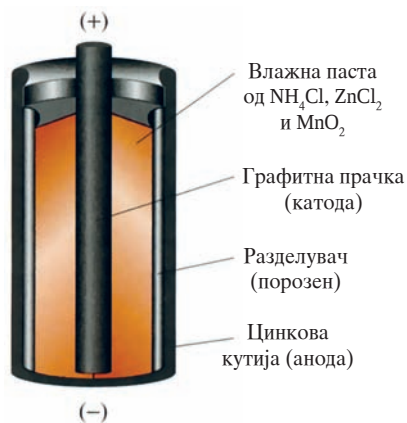
▲ Слика 18.16 Напречен пресек на Лекланшеева (Leclanché) (сува) ќелија
