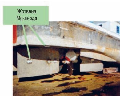
▲ Жртвената магнелиумова анода што е закачена за челичната структура на бродот обезбедува заштита од корозија.
