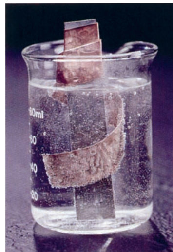
▲ СЛИКА 18.11 Уред составен од бакар и од цинк потопени во \text{HCl}(\text{aq}) .
