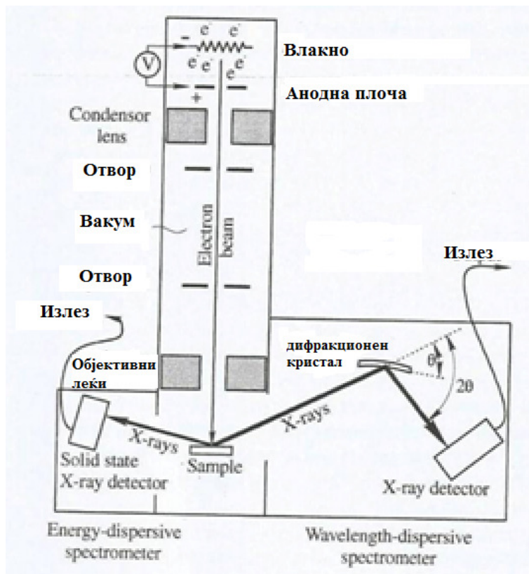
Слика 5.1 Шематскиот приказ ги покажува главните елементи на техниката на електронска микропроба. Излезите на двете браново-должински дисперзивен спектрометар и енергетско дисперзивен спектрометар се спроведуваат до компјутер за анализа. Види го текстот за дополнителна дискусија.
