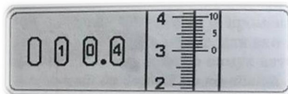
Сл. 2. Отчитување на измерената вредност на Mettler-вага
