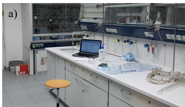
Слика ?? лабораториски маси изработени од различен материјал со површина од а) монолитна керамика, б) дрво премачкано со огноотпорна анилинска боја.
