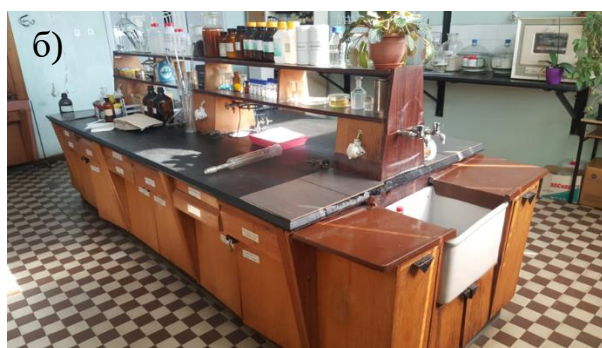
Слика ?? лабораториски маси изработени од различен материјал со површина од а) монолитна керамика, б) дрво премачкано со огноотпорна анилинска боја.
