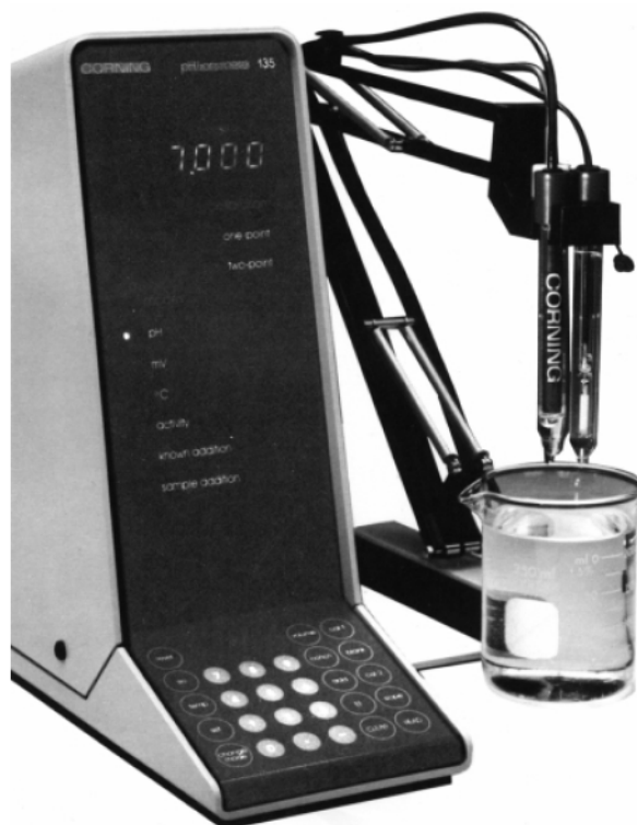
Сл. 8. Модерен pH-метар контролиран со микропроцесор.
