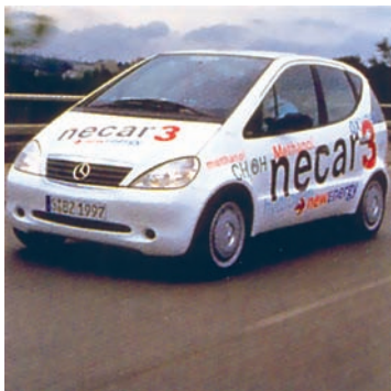
▲ Прототипот на Дајмлер-Бенз, NECAR 3 се движи на горивна ќелија. Водородот се произведува во самиот автомобил од метанол.
