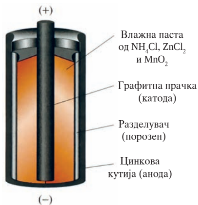
▲ Слика 18.16 Напречен пресек на Лекланшева (Leclanché) (сува) ќелија
