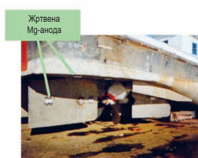
▲ Жртвената магнезиумова анода што е закачена за челичната структура на бродот обезбедува заштита од корозија.
