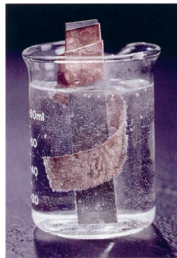
▲ СЛИКА 18.11 Уред составен од бакар и од цинк потопени во \text{HCl}(\text{aq}) .
