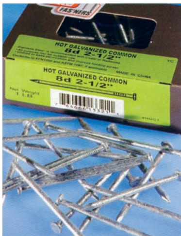
▲ Галванизирани клинци се добиваат со потопување челични клинци во стопен цинк за да се продолжи нивниот век.
