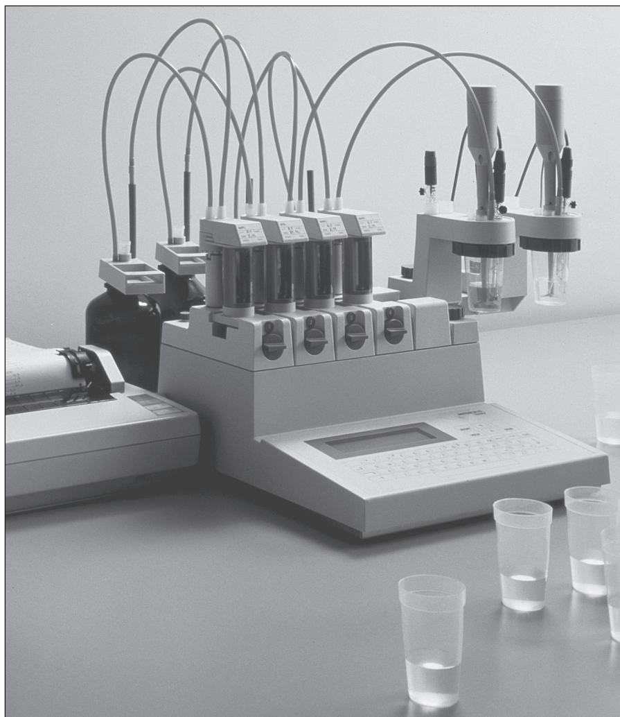
Слика 9.5 Типичен инструмент за изведба на автоматизирана титрација. Со дозвола од Fisher Scientific.
